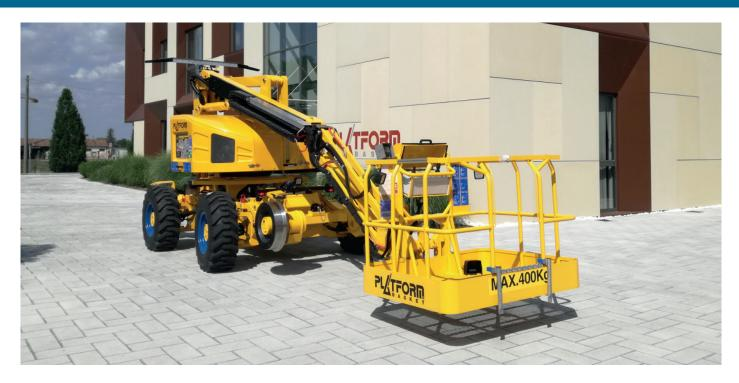
La RR 14 EVO è una piattaforma di lavoro bidirezionale versatile, specialmente progettata per affrontare le sfide della costruzione e della manutenzione sui binari.
